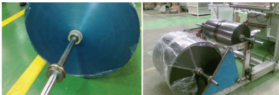
Bobina con eje colocado
