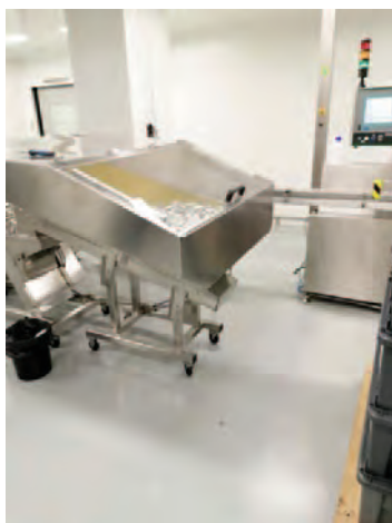
Tolvas donde se deben vaciar los aerosoles
