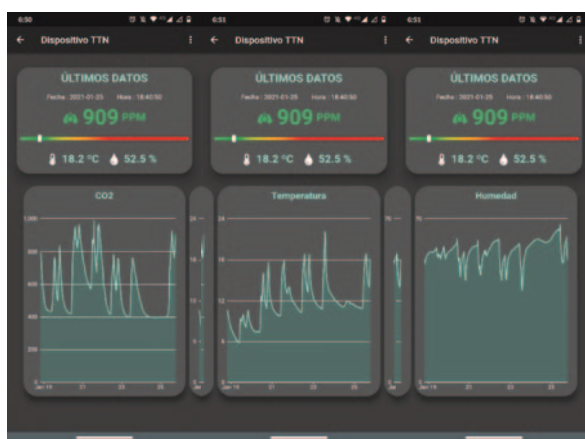
Imagen 6 Información de la App (CO 2 , Temperatura y Humedad)
