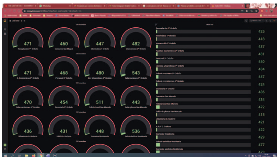
Imagen 7 - Panel de control AI sistema se le puede incorporar la medición de otro tipo de parámetros: concentración de Oxígeno, CO, etc... instalando los sensores adecuados.
